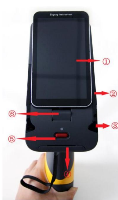
PDA Indicador de radiación Indicador de encendido Puerto de alimentación externo Interruptor de encendido; Eje de rotación de PDA
